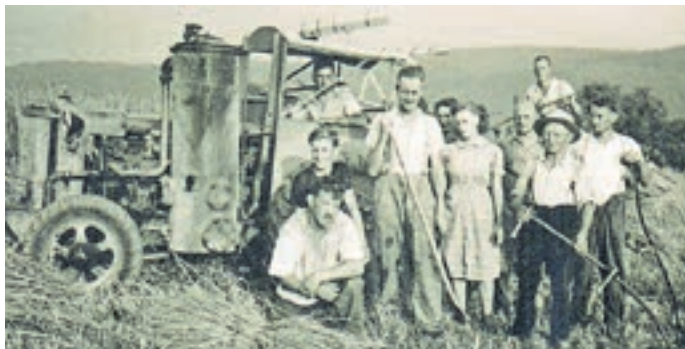
Frucht mähen mit einem Holzvergaser-Traktor, ca. 1940
